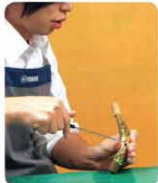
② バネが利いているので、キを押えながらネジにドライバーを当てて回す
