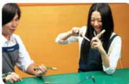
⑤ ネジが指で抜けない場合はペンチを使用する
