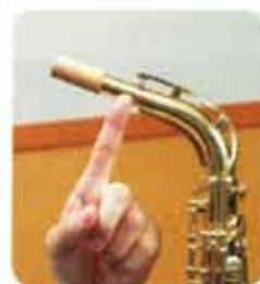
17 オクターブ・キィと本体側の接点部分の遊びがなくなり、キィが浮いた状態
