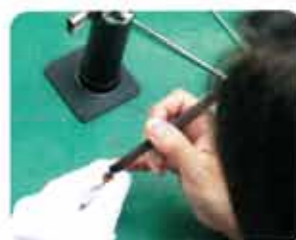
⑧ ホットメルト(接着剤)をバーナーで溶かしてタンポの裏面に着ける
