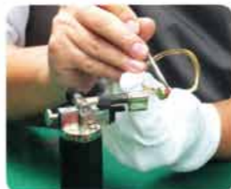
① バーナーで熱しながらドライバーの先をタンポに引っ掛けて、掻き落とす
