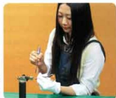
② ネックの裏側から熱することで接着剤を溶かし、タンポを外れやすくする
