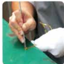
③ タンポ皿に接着剤がたかさん残っている場合はドライバーで削り取る
