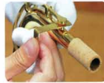
12 平均に穴がふさがる位置にタンポの向きを平らにするように、熱したタンポをヘラを使って調整する
