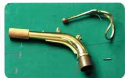
③ ネック(左)、オクターブ・キ(右上)、ネジ(右下)が分解された状態
