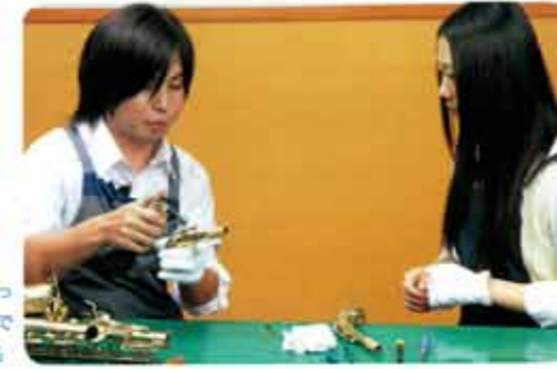
13 バーナーで炙った後にヘラでタンポを調整する
