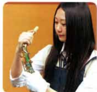
16 オクターブ・レバーを手で曲げる
