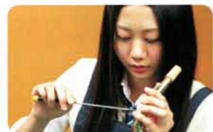
④ ネジを回してネックとオクターブ・キを分解
