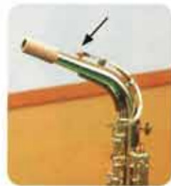
15 オクターブ・キィと本体側の接点部分の隙間が少ししかない状態
